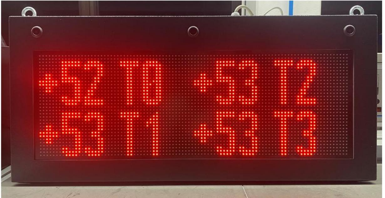
Sul display consegnato viene definito un layout composto da quattro elementi di testo con i nomi appropriati.
